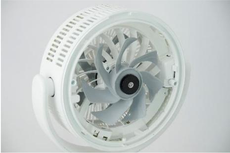
モーターを本体背面に設置しないことで背面から大量の風を取り込み、2枚の羽根で送り出す「W ファン構造」により、パワフルな風を生み出します。1枚羽根の場合と比べて風速は約35%UP。また、最大約14m先まで風を届けることができます。
