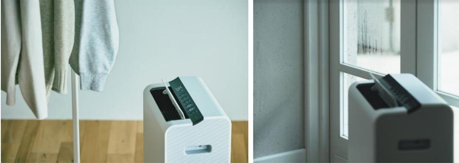
乾燥剤が吸着した水分をヒーターであたためた後、熱交換器で水滴にする、デシカント式を採用。室温が下がっても除湿能力が下がりにくいいため、花粉シーズンの室内干しや梅雨の時のカビ対策、冬場の結露防止など、一年を通じて活躍します。
