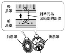
**2** 使前扇罩向右轉動,前扇罩的凹陷部(□)與後扇罩的凸出部(□)位置對準並固定
