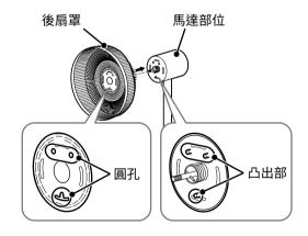
(2) 將扇罩固定螺母插入馬達軸,順時針轉動並牢牢固定
